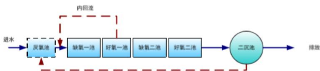
图 3.4-4 改良 bardenpho 工艺流程图
