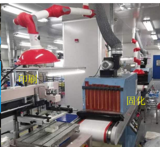
图 6.1-4 印刷、固化废气收集示意图
