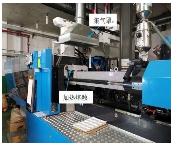
图 6.1-3 注塑废气收集示意图
