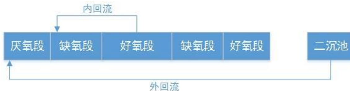
图 4.4.6-4 改良 bardenpho 工艺流程图
